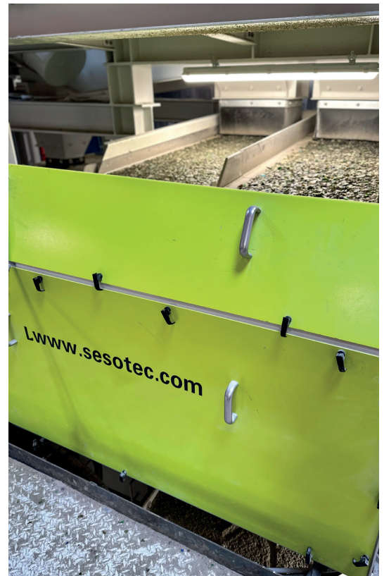
Reiling setzt zur Sortierung von dunklen Glasscherben Sesotec SPEKTRUM Glassortiersysteme mit speziellem C-C Sensor ein, um die Glasrückgewinnung deutlich zu verbessern (Foto: Reiling Gruppe)
