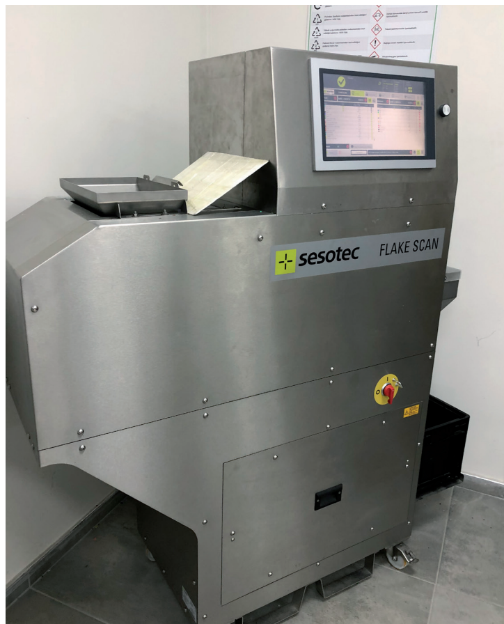
Sesotec Materialanalysesystem FLAKE SCAN für Qualitätsanalysen innerhalb von Minuten
