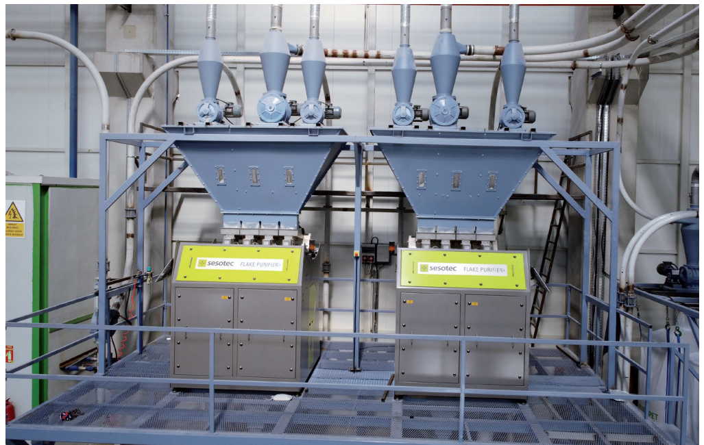
Effiziente Feinsortierung von PET-Flakes durch FLAKE PURIFIER+
